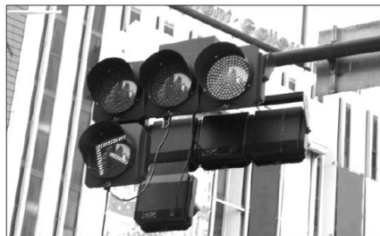
LED 式の信号。車両用信号機は全体の約半分にあたるおよそ 65 万灯が LED 化されている。
